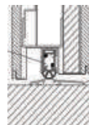
accoppiamento telaio e controteleggiato
