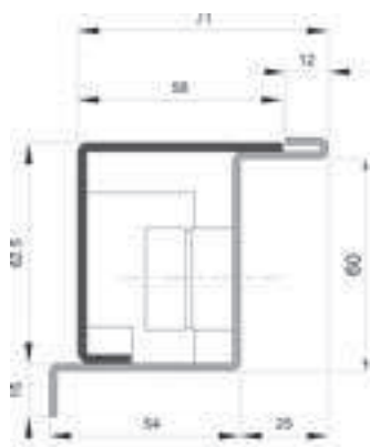
accoppiamento telaio e contro telaio
